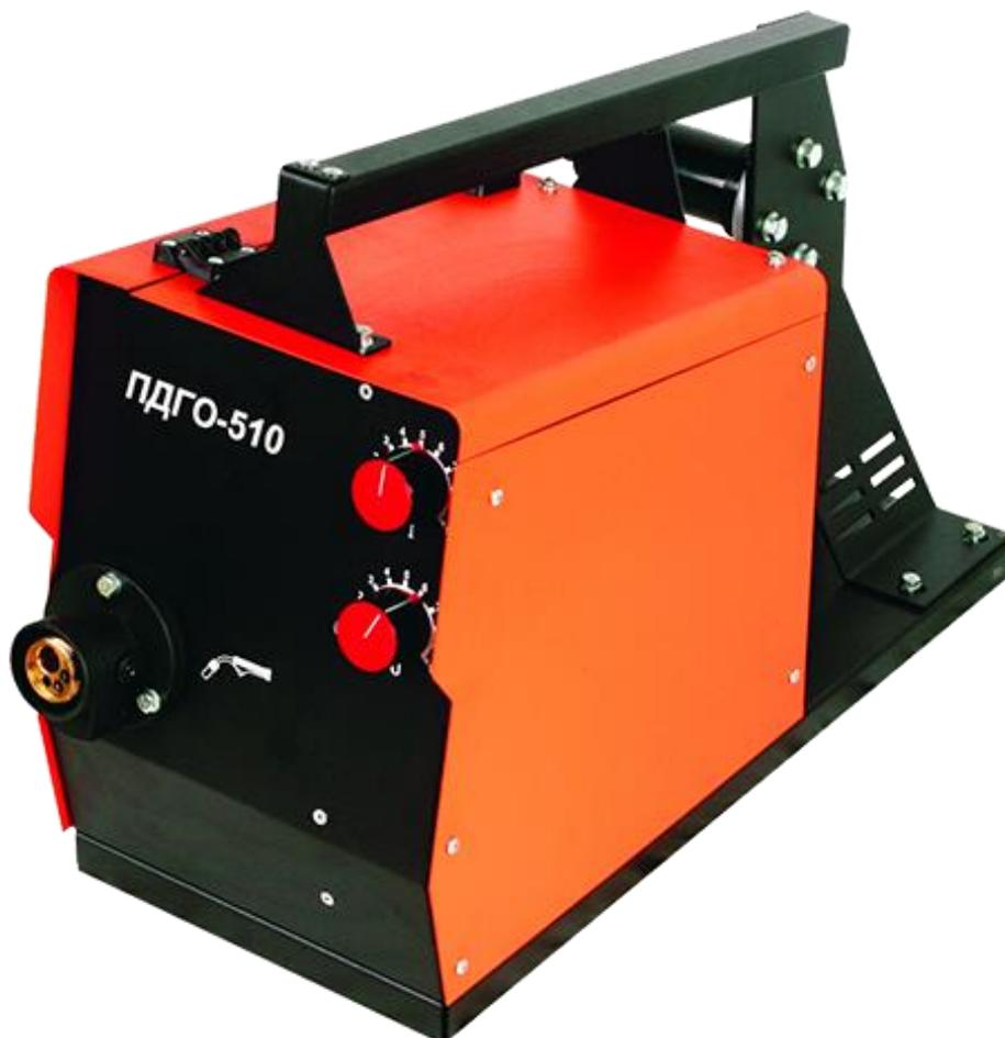
Полуавтомат **ПДГО-510** в комплекте с источником для МИГ/МАГ сварки предназначен для полуавтоматической сварки плавящейся электродной проволокой в среде защитных газов. Полуавтомат имеют независимое, плавное регулирование скорости подачи электродной проволоки, которое регулируется ручкой потенциометра, расположенного на механизме подачи.
