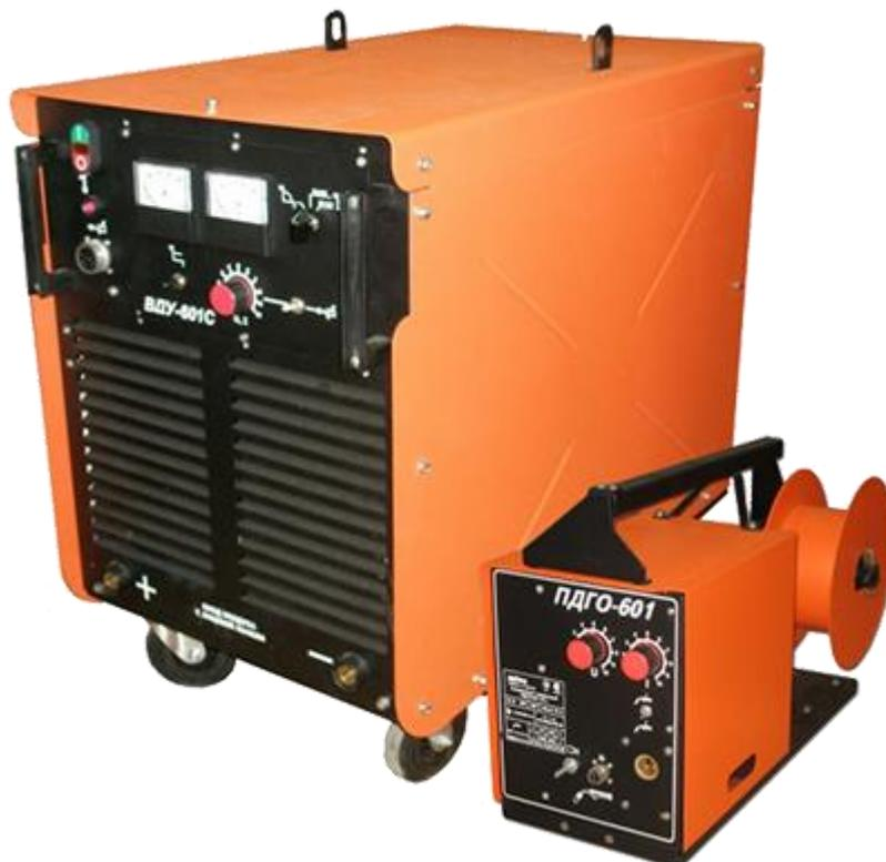
Комплектный полуавтомат ПДГО-601 с ВДУ-601С предназначен для сварки на постоянном токе с использованием плавящегося электрода в среде защитных газов, в качестве плавящегося электрода может использоваться любой тип сварочной проволоки диаметром от 1 до 3,2 мм.
