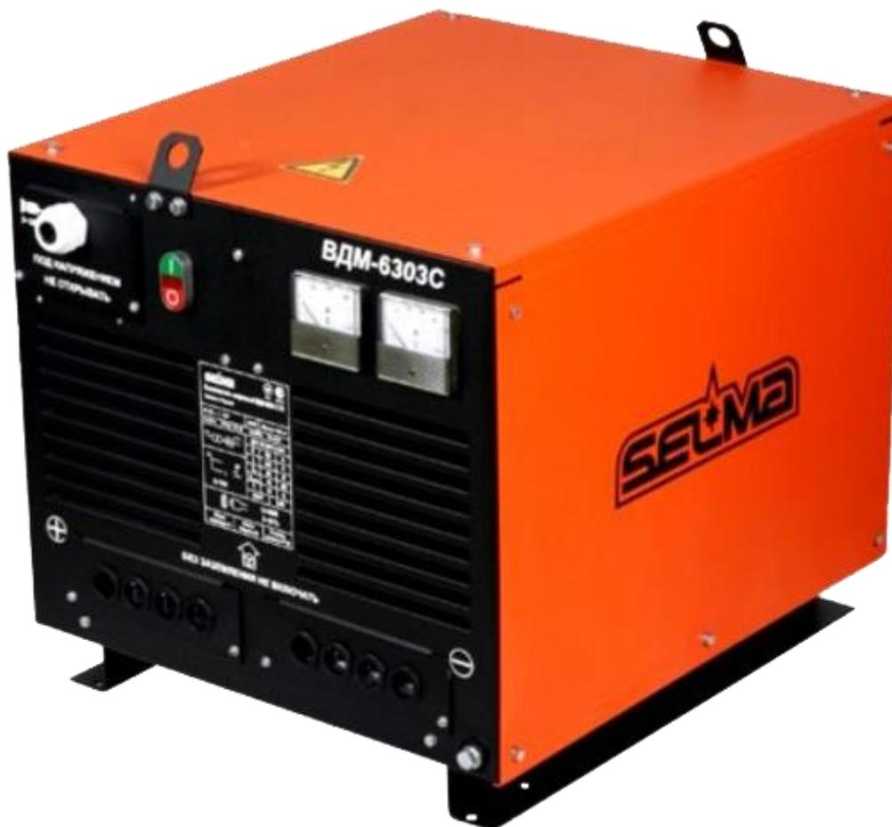
Выпрямитель сварочный многопостовой типа **ВДМ-6303С** предназначен для комплектации постов ручной дуговой сварки покрытыми электродами изделий из углеродистых и легированных сталей на постоянном токе. Выпрямитель может применяться в стационарных условиях в комплекте с балластными реостатами типа РБ-302, РБ-306. Выпрямитель не регулируемый и имеет жесткую внешнюю характеристику.
