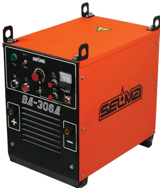
Выпрямитель однопостовой **ВД-306Д** предназначен для ручной дуговой сварки углеродистых, легированных и коррозионностойких сталей на постоянном токе, а также для аргодуговой сварки на постоянном токе всех металлов кроме алюминия при комплектации выпрямителя БУСП-ТИГ и ВСД-02.
