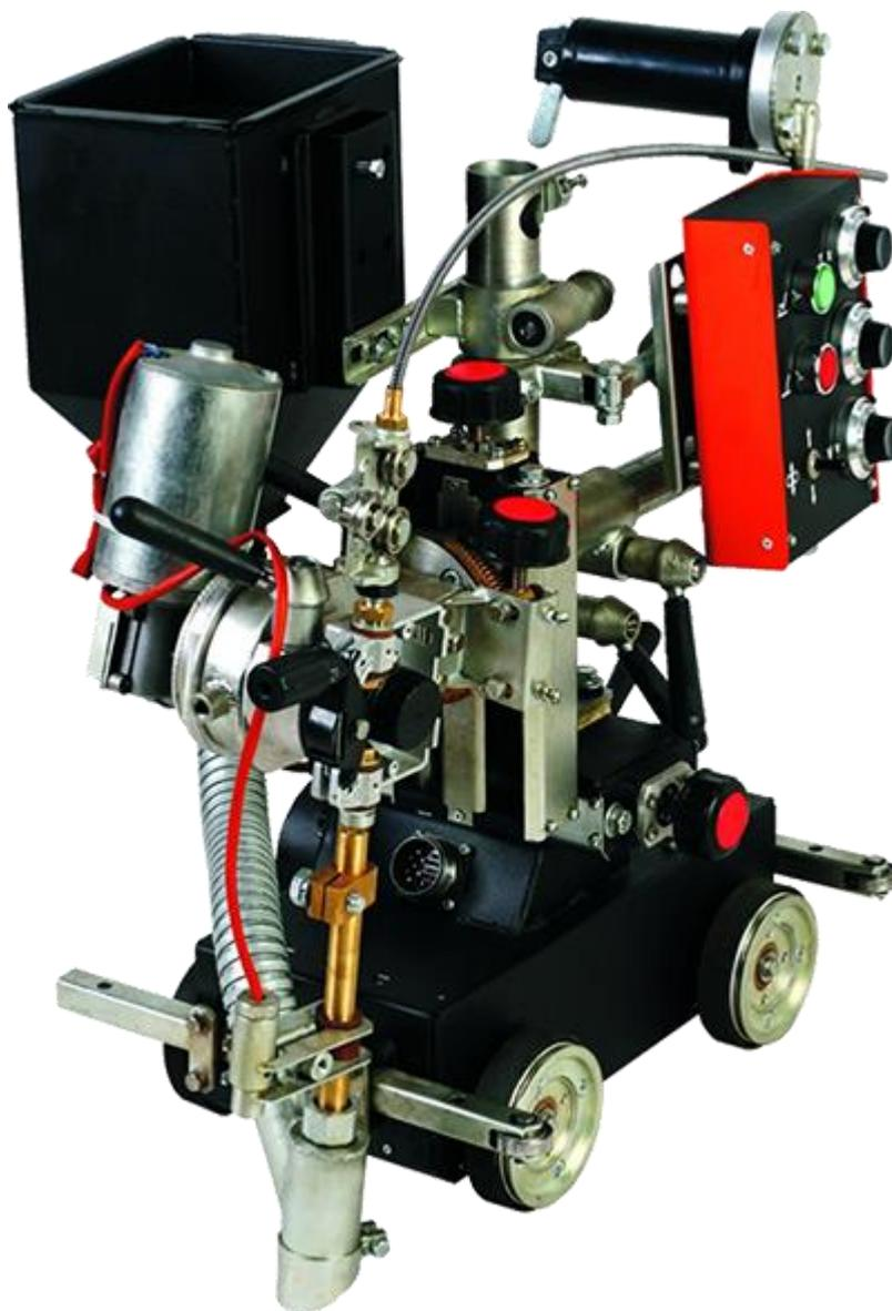
**Сварочный автомат (трактор) АДФ-630** в комплекте с источником сварочного тока предназначен для автоматической сварки под слоем флюса малоуглеродистых и низколегированных сталей.
