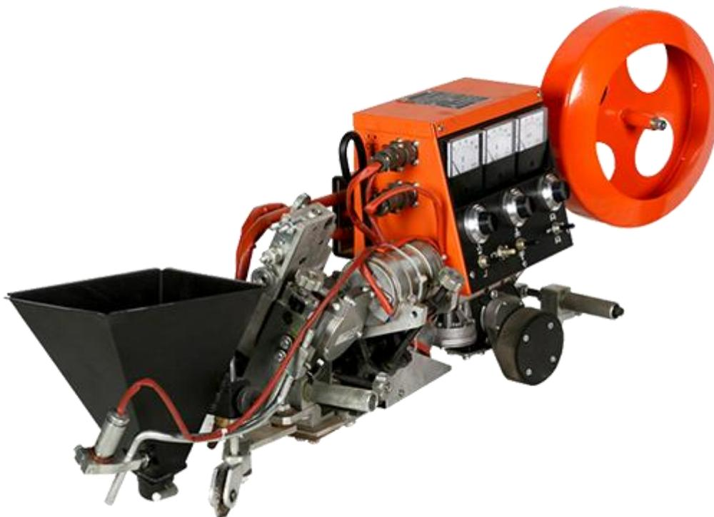
**Сварочный автомат (трактор) АСУ-5** предназначен для сварки под слоем флюса угловых швов прямолинейных, криволинейных и кольцевых ребер жесткости.
