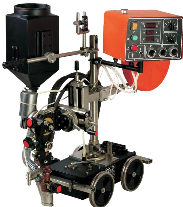
**Сварочный трактор АДФ-1000** предназначен для автоматической электродуговой сварки прямолинейных угловых, тавровых, нахлесточных, стыковых швов с разделкой и без разделки кромок.
