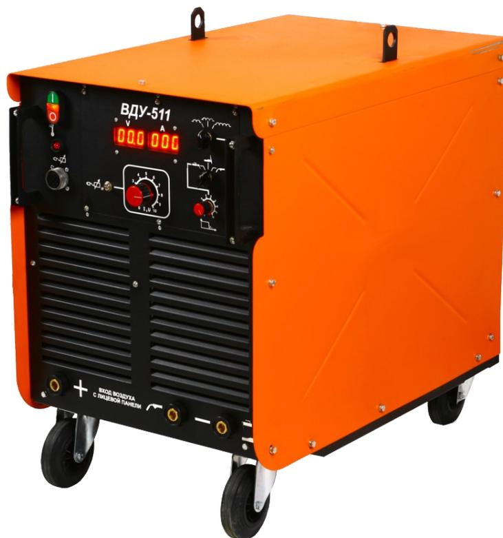
Универсальный сварочный выпрямитель **ВДУ-511** предназначен для комплектации полуавтоматов, производящих сварку малоуглеродистых, легированных и коррозионностойких сталей в среде защитных газов; ручной дуговой сварки на постоянном токе; аргонодуговой сварки (в комплекте блоком управления БУ-ТИГ) на постоянном токе всех металлов за исключением алюминия.
