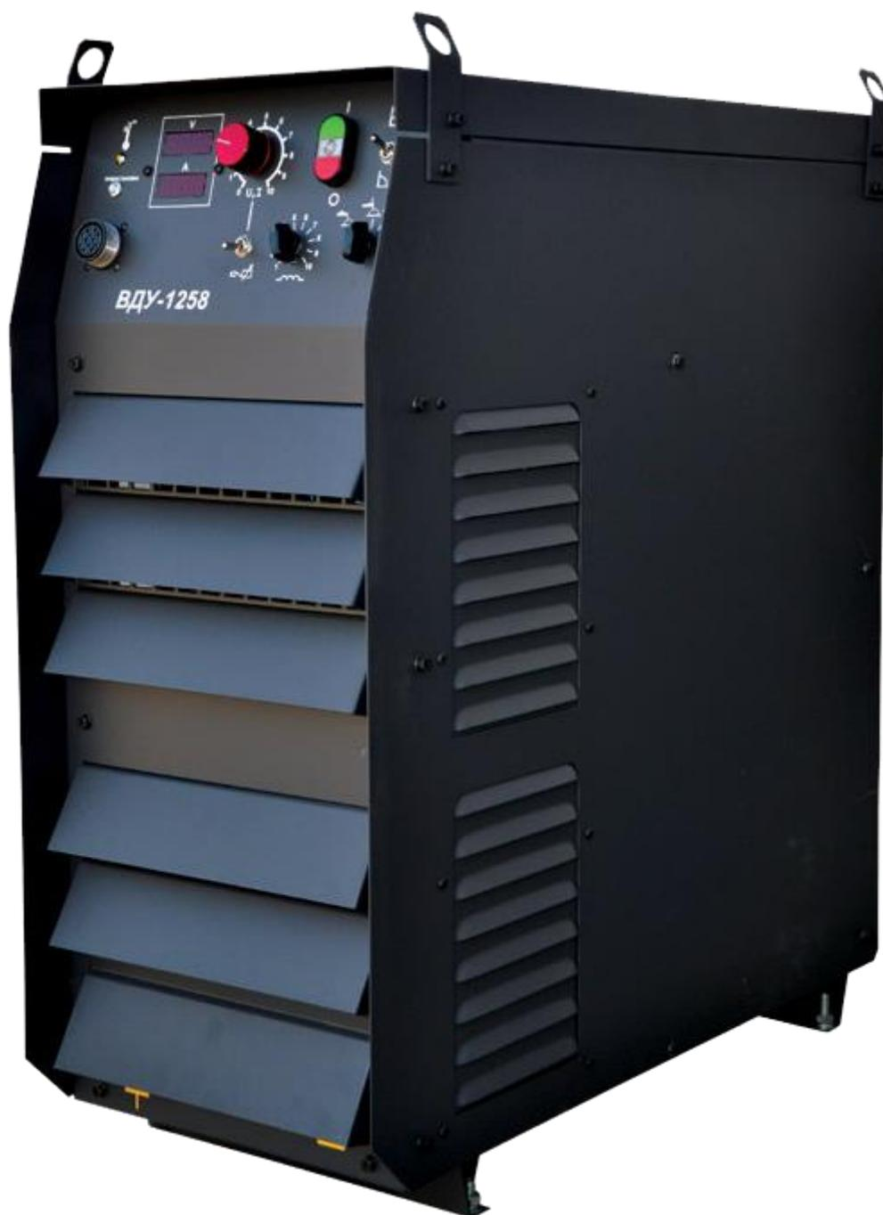
Инверторный сварочный выпрямитель ВДУ-1258 (Пионер-А1200) предназначен для комплектации автоматов для сварки и наплавки под слоем флюса и в среде защитного газа. Выпрямитель также может быть использован для полуавтоматической сварки плавящимся электродом в среде защитного газа MIG-MAG, для сварки углеродистых,
